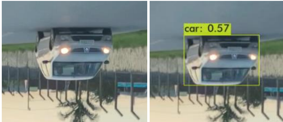
Figura 30: Original (esq.) e caixa delimitadora prevista pelo algoritmo (dir.)
