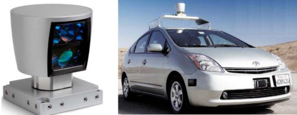
Figura 5: Sensor LiDAR HDL-64E (esq.) Montagem em um Toyota Priuse (dir.)
