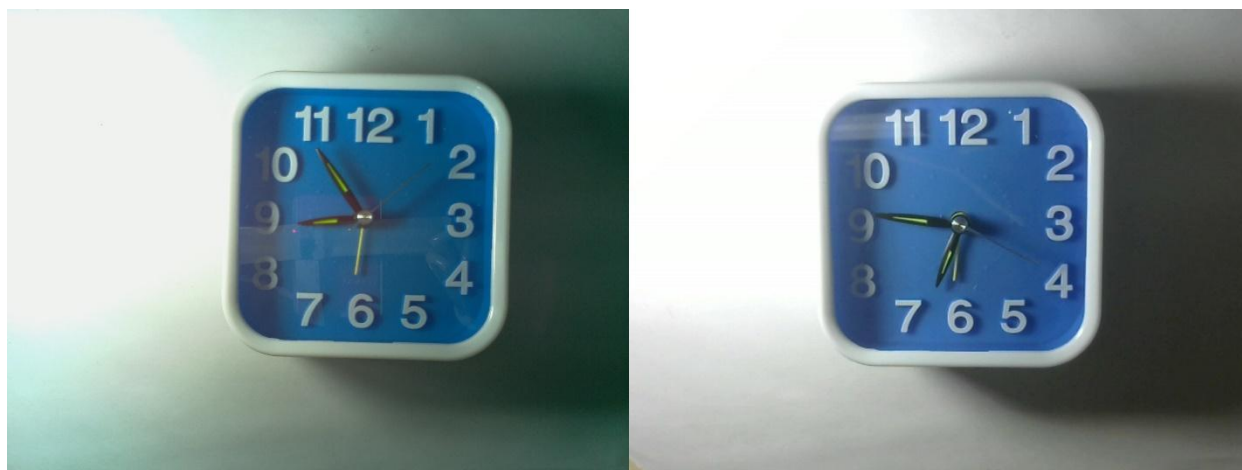
Figura 37: Iluminação direcional frontal difusa capturada por Logitech C270 (à direita) e Raspberry Pi Camera v1
