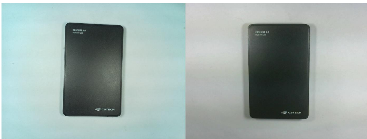
Figura 38: Iluminação frontal difusa capturada por Logitech C270 (à direita) e Raspberry Pi Camera v1
