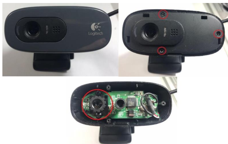
Figura 24: Método para alterar o foco da câmera Logitech C270
