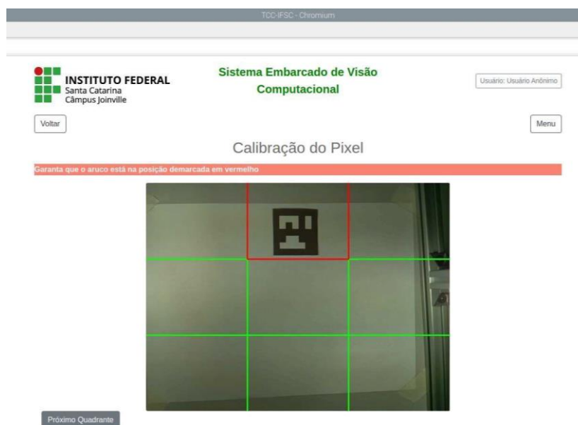
Figura 67: Sistema de visão embarcada com câmera Raspberry Pi Camera v1 a 345 mm do plano
