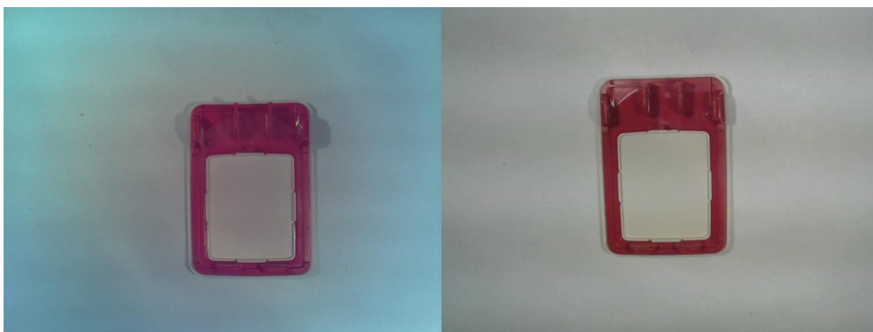
Figura 42: Lâmpadas halógenas como fonte de luz capturada por Logitech C270 (à direita) e Raspberry Pi Camera v1
