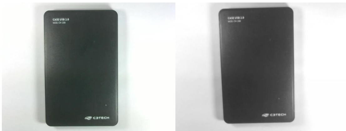
Figura 48: Imagem adquirida em escala de nível cinza (à esquerda) e imagem com filtro gaussiano aplicado
